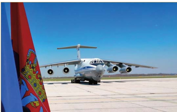
Транспортни авион Ил-76 на стајанци. Има дужину 46,6м, распон крила 50,5 м и висину 14,8 м. Тежак је 72 празан, а максимално 157 тона. Носи 50-60 тона терета или 225 војника.
