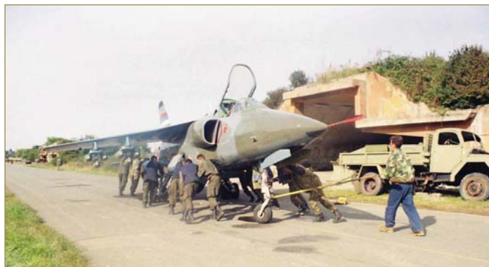
Ручни систем увлачења наоружаног авиона Орао у армиранобетонско склониште (фото Драго Вејновић)
