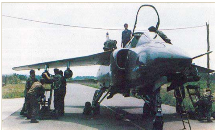
Оружари ВРС наоружавају авион Орао са НРЗ калибра 57 мм (фото Нова крила)
